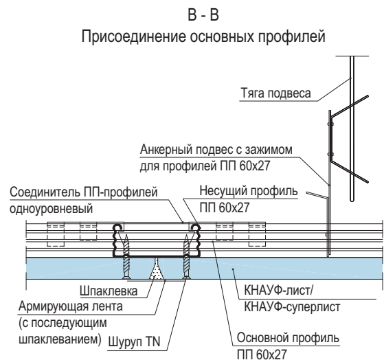
Г - Г Присоединение основных профилей
